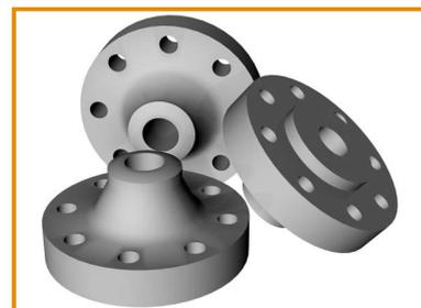
**Описание:** Приварной встык фланец за счет конструктивных особенностей выдерживает давление до 20 МПа. Монтаж такого фланца, по сравнению с плоским приварным фланцем, предусматривает только один соединительный сварной шов, что упрощает работу и сокращает временные затраты, а также позволяет контролировать качество сварного шва по месту монтажа.
