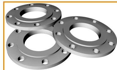
**Описание:** Фланцы используются для соединения двух участков трубы, а также для присоединения оборудования к трубе. При монтаже плоский фланец одевается на трубу и приваривается двумя сварными швами. Наиболее распространены фланцы из стали 20 с исполнением уплотнительной поверхности 1 – соединительный выступ.
