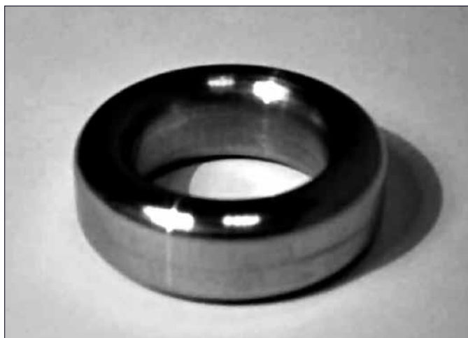
Рис. 2 Твёрдость металла прокладок выше твердости металла фланцев
