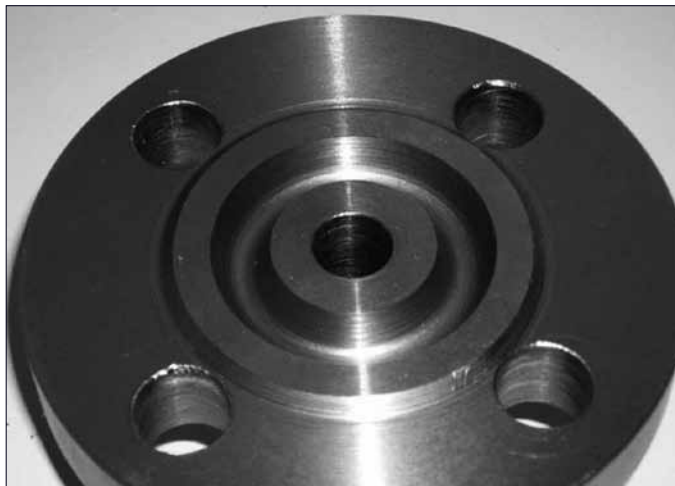
Рис. 4 Твердость металла прокладок ниже твердости металла фланцев
