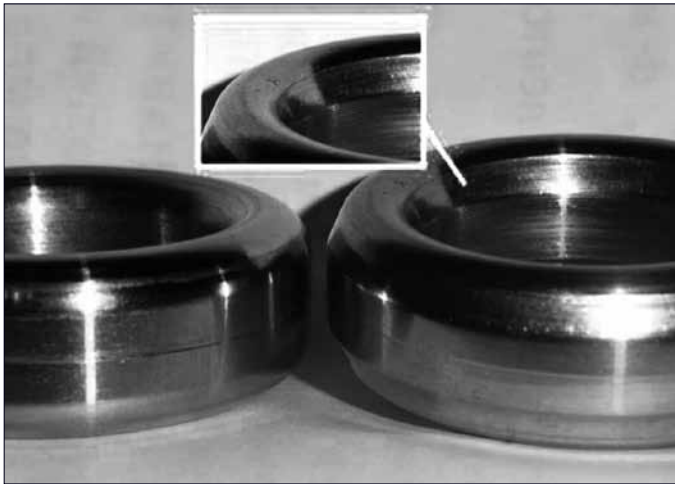
Рис. 3 Твердость металла прокладок ниже твердости металла фланцев
